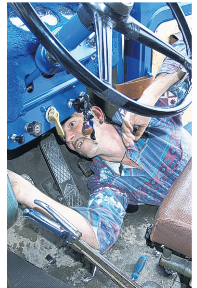
Rico Pedretti demontiert im ZDM einen defekten Luftschlauch.
